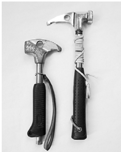
Obr. 114 Kladivo s tupým zobákem určené pro osazování nýtů a typické skalní kladivo
