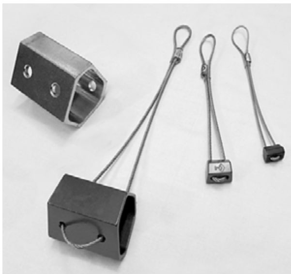
Obr. 149 Torzní a výstředníkové vklíněnce typu hexentrik
