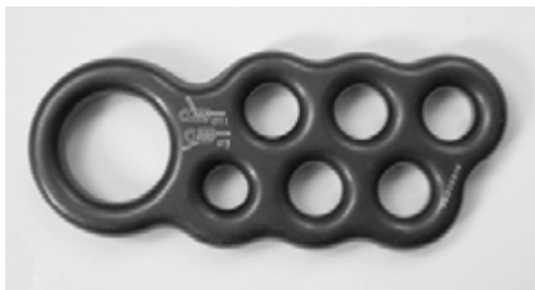
Obr. 104 Lanová brzda. Otvory mají průměr 11,5 mm, pouze jeden (vždy je na výrobku označen) má průměr 9 mm pro případ použití slabšího lana
