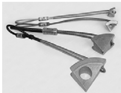
Obr. 151 Abalak s populárními ocelovými lany od českých firem Kouba a Viamont
