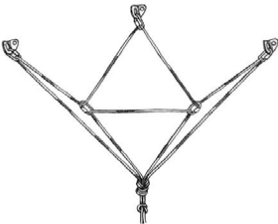
Obr. 38 Schéma plovoucího kotvení s použitím dvojitého osmičkového uzlu
