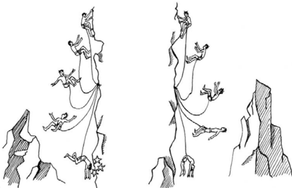
Obr. 67 Dvě ukázky možného průběhu pádu lezce navázaného pouze v sedacím úvazu (podle výzkumů DAV publikovaných P. Schubertem)
