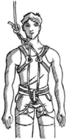
Obr. 69 Provázání navazovacích ok prsního a sedacího úvazu osmičkovým uzlem
