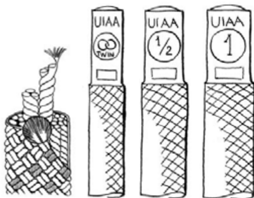
Obr. 3 Konstrukce a značení horolezeckých lan. Písmeny, logem CE, logem UIAA a symbolem pro kategorii lana musejí být označeny oba konce lana
