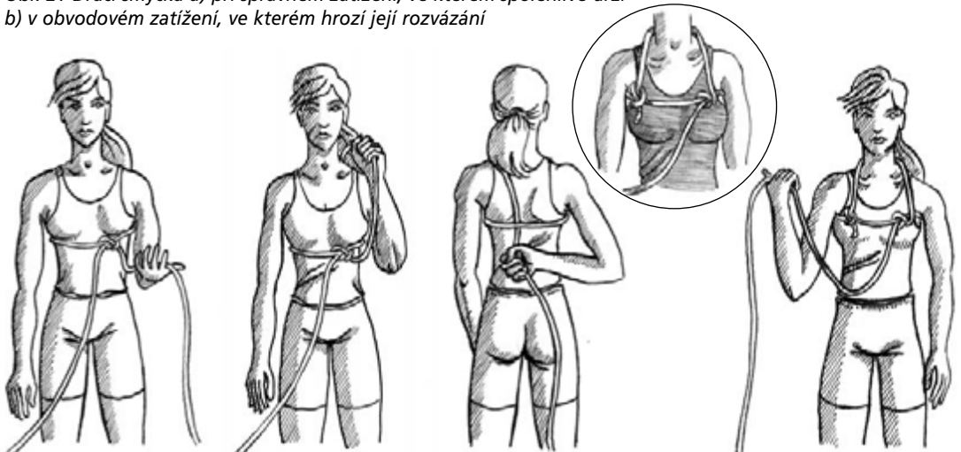
Obr. 22 Použití dračí smyčky k uvázání nouzového prsního úvazu, tzv. kšandiček
