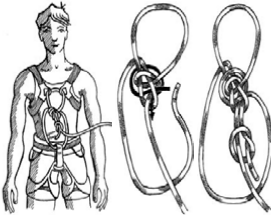
Obr.72 Provázání sedacího a prsního úvazu dračí smyčkou
